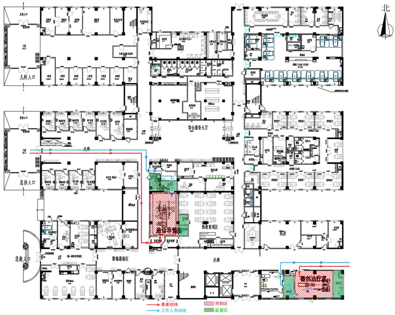
图 11-1 DSA 辐射场所分区和路由平面布局图
